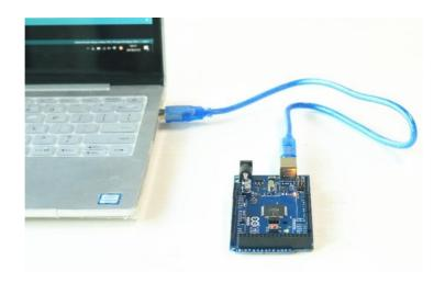
(3) 在 Arduino IDE 中打开固件,按下图所示设好参数,将固件发送至 Arduino Mega2560。
